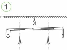
Usar tornillos para fijar la base en el techo.
